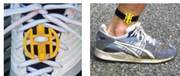
Abb. 2: Anbringung des ChampionChip®: links für Einzelläufer, rechts mit Klettband für Duo- und Team-Marathonläufer
